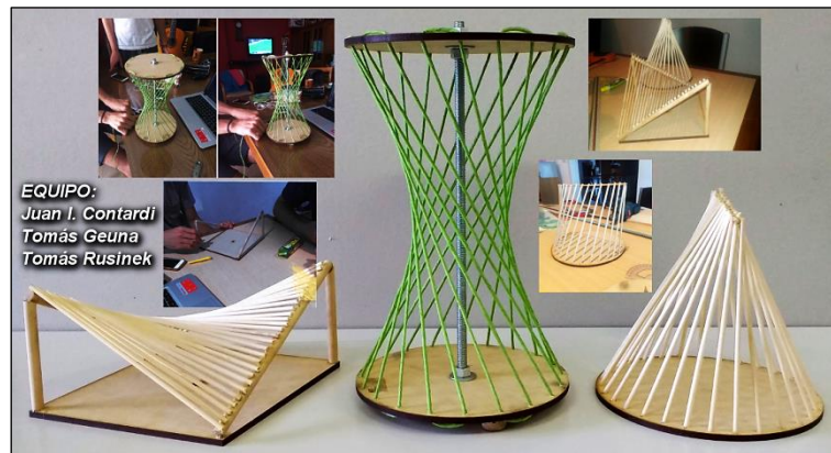
Figura 8. Maquetas de estudio con varillas de madera y cordón elástico con tornillo sinfin. Fuente: Equipo: Juan I. Contardi, Tomás Geuna y Tomás Rusinek
