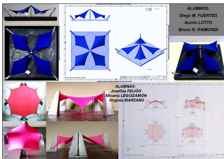
Figura 11. Tenso-estructuras textiles de forma paraboloides hiperbólicas. Fuente: Equipos: D. Fuentes, A. Lotto, N. Raimondi – J. Feijóo, M. Leguizamón, V. Marzano.
