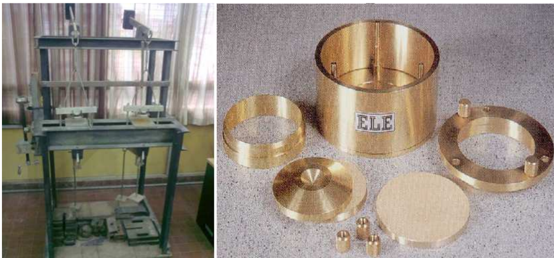
Figura 13 Consolidómetro del laboratorio del IMAE – Anillo metálico desarmado
