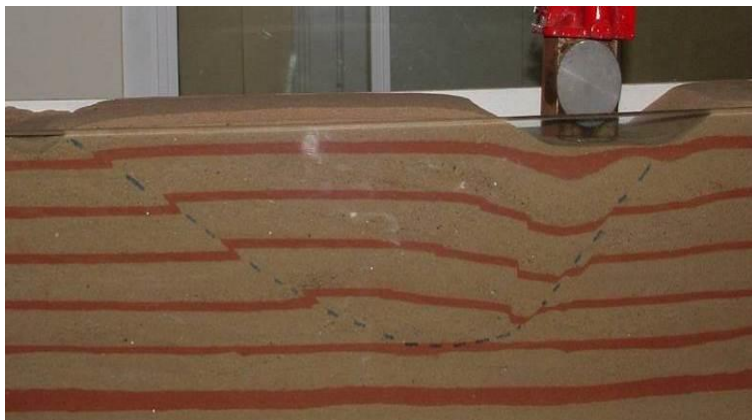
Figura N° 3.1a: Falla de una base apoyada sobre un manto de arena en un ensayo en modelo realizado en el Laboratorio de Mecánica de Suelos de la Facultad de Ingeniería
