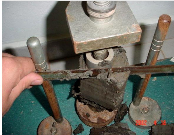
Figura N° 3.26 a: Torno manual que permite el recorte de probetas cilíndricas
