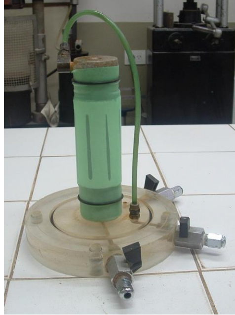
Figura N° 3.41: Probeta de arcilla con drenaje lateral construido con papel de filtro
