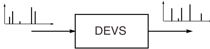
Figura 3.2: Comportamiento Entrada/Salida de un modelo DEVS
