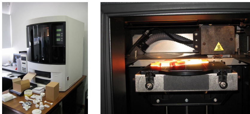
Figura 3. Impresora de maquetas 3D y detalle interior.
