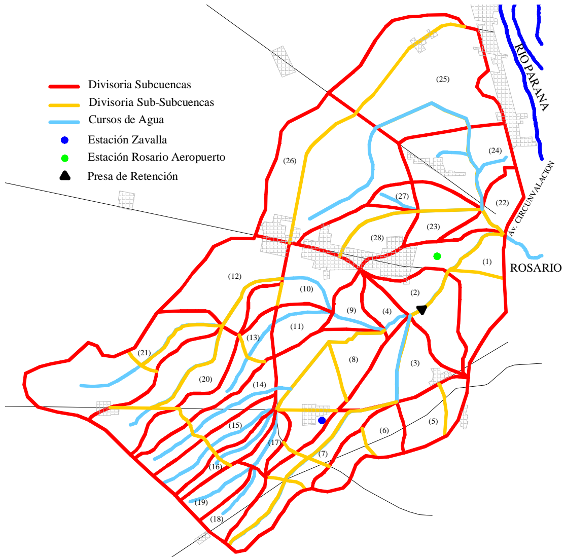
Figura 2.- Delimitación de subcuencas y sub-subcuencas en el Sistema Hidrológico del A° Ludueña.
