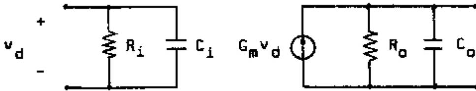
**Figura 12.** Modelo simplificado para el diferencial de entrada.
